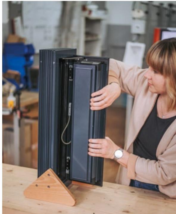
**LE DÉCOUPLAGE DES COQUES INTÉRIEURE ET EXTÉRIEURE PERMET DE RÉDUIRE AU MINIMUM L'EFFET BIMÉTALLIQUE.**
